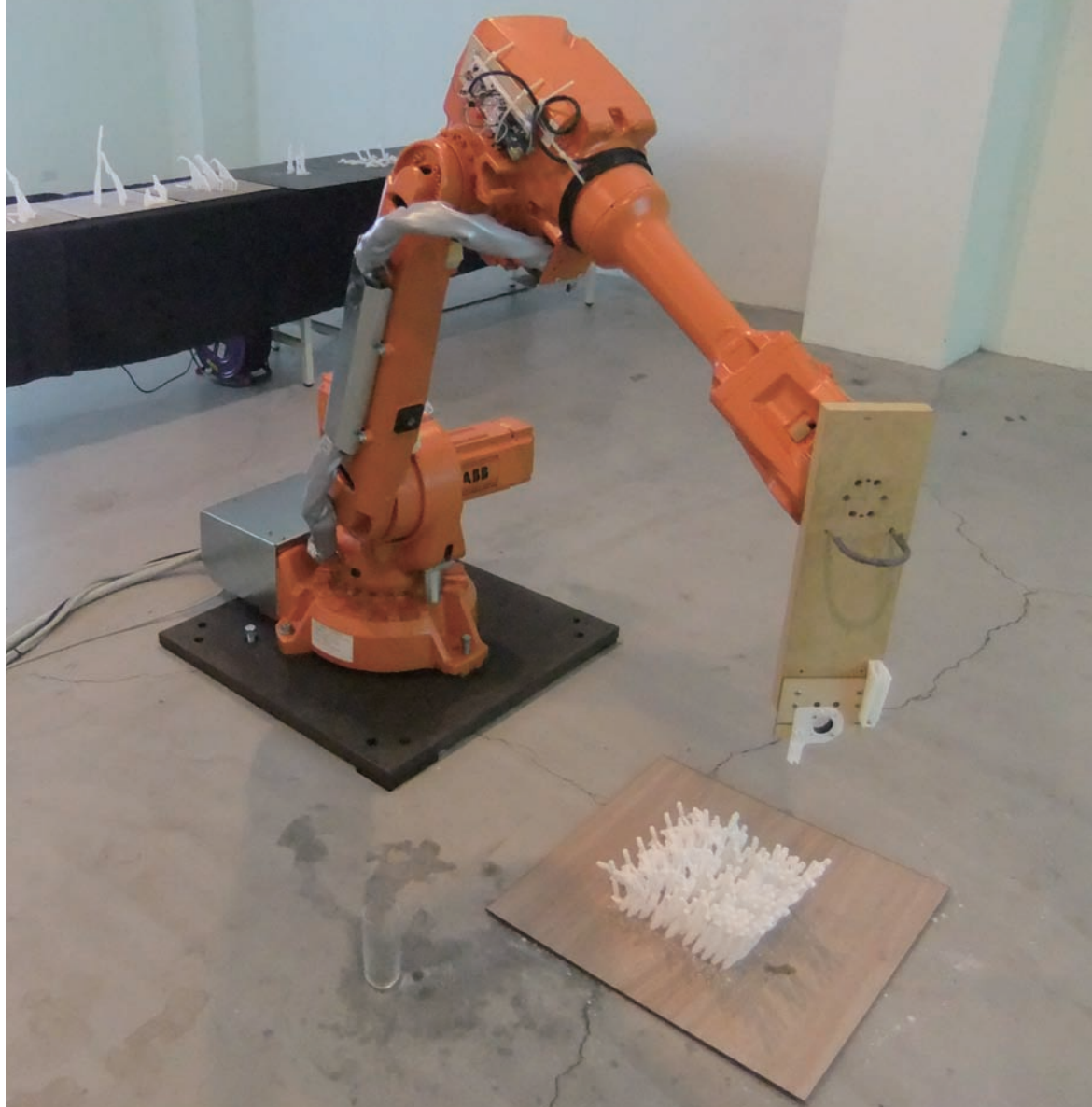
圖2 機器手臂製造醋酸鈉鹽雕塑，ARM機器手臂工作營，2013。
