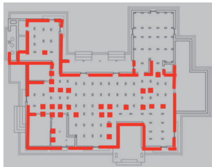
現存舊有基礎
