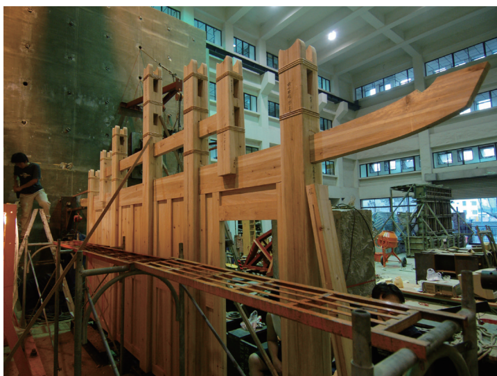
圖4成大建築進行穿鬮式構架足尺實驗
